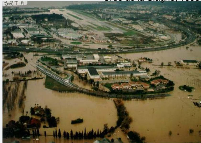
La Siagne sera donc préférentiellement franchie en **viaduc et remblai** et toute entrée de tunnel devra être réalisée hors du zonage d'inondabilité
