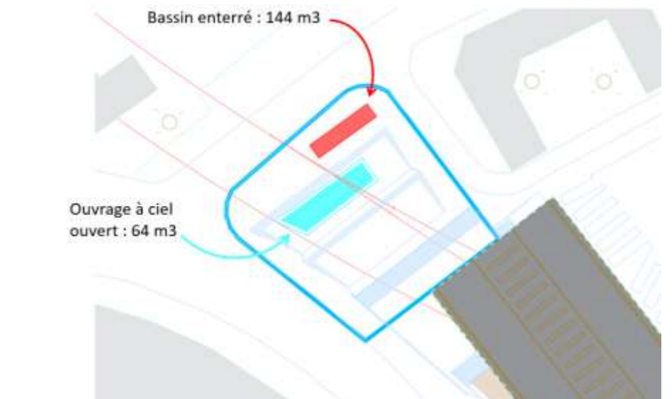
Figure 219 : Ouvrages de rétention place Victor Hugo ( AREP, 2021)
