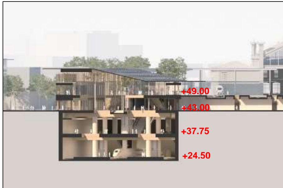
Figure 41: répartition des différents niveaux de la gare
