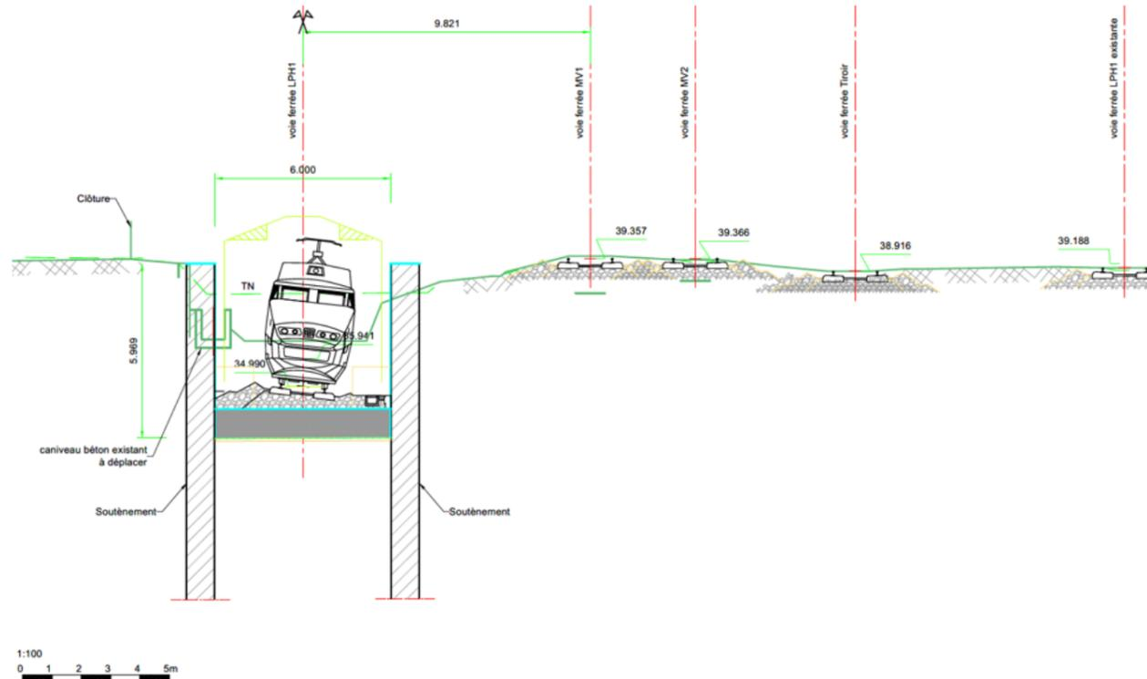
Figure 14 : Vue en coupe de la rampe d'accès ouest du terrier (Egis, 2021)
