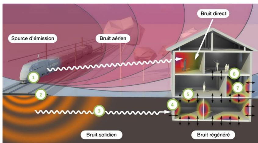
Figure 92 Phénomènes vibro-acoustiques au passage d'un train (Egis/ACOUSTB)
