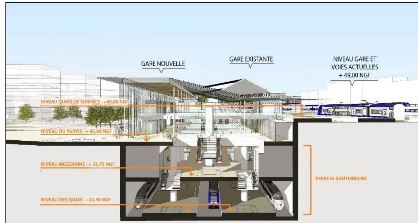
Figure 29 : Les différents niveaux de la gare nouvelle (AREP 2021)
