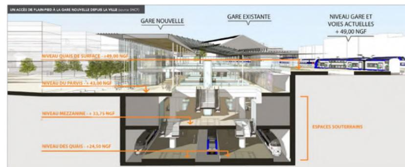
Figure 192 : Les niveaux de la gare existante et de la gare nouvelle
