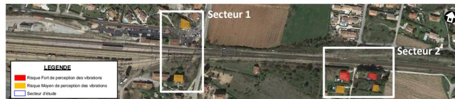
Figure 156 : identification des probabilités de perception vibratoires à l'intérieur des bâtiments situés à proximité directe des voies ferroviaires (Systra, 2021)
