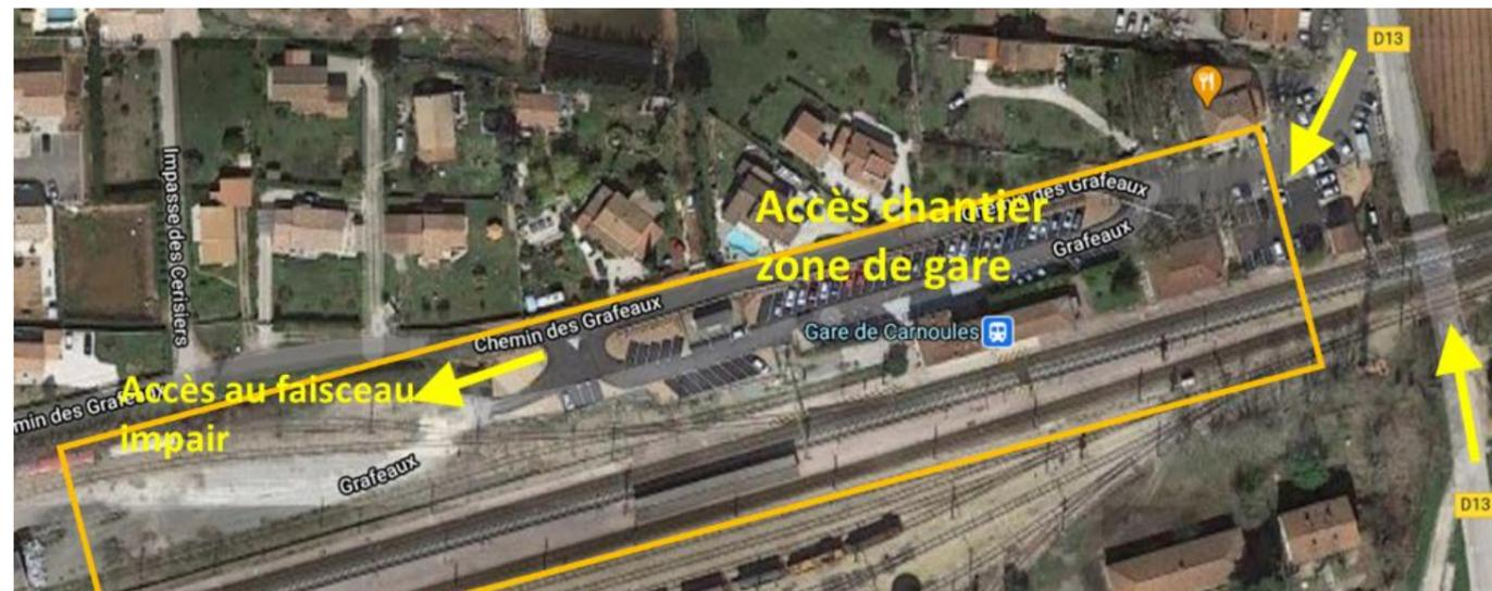
Figure 42 : accès chantier à la zone de gare (Systra, 2021)
