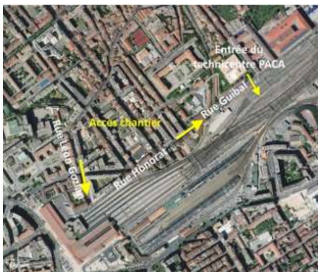
Figure 37 : accès possibles au chantier (source : Systra, 2021)
