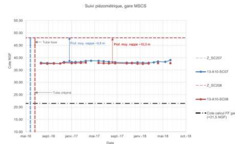
Figure 46 : suivi piézométrique au droit de la gare Marseille Saint-Charles (Source : Etudes de recalage du programme d'opération (2018-2019), Rapport de présentation du secteur de Marseille Souterrain, 2019)
