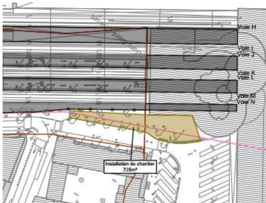
Figure 35 : zone d'installations de chantier rue Honnorat
