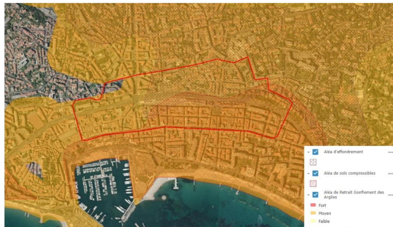
Figure 42 : Exposition au retrait gonflement des argiles et risque de mouvements de terrain sur le secteur de Cannes Centre (Géorisques)
