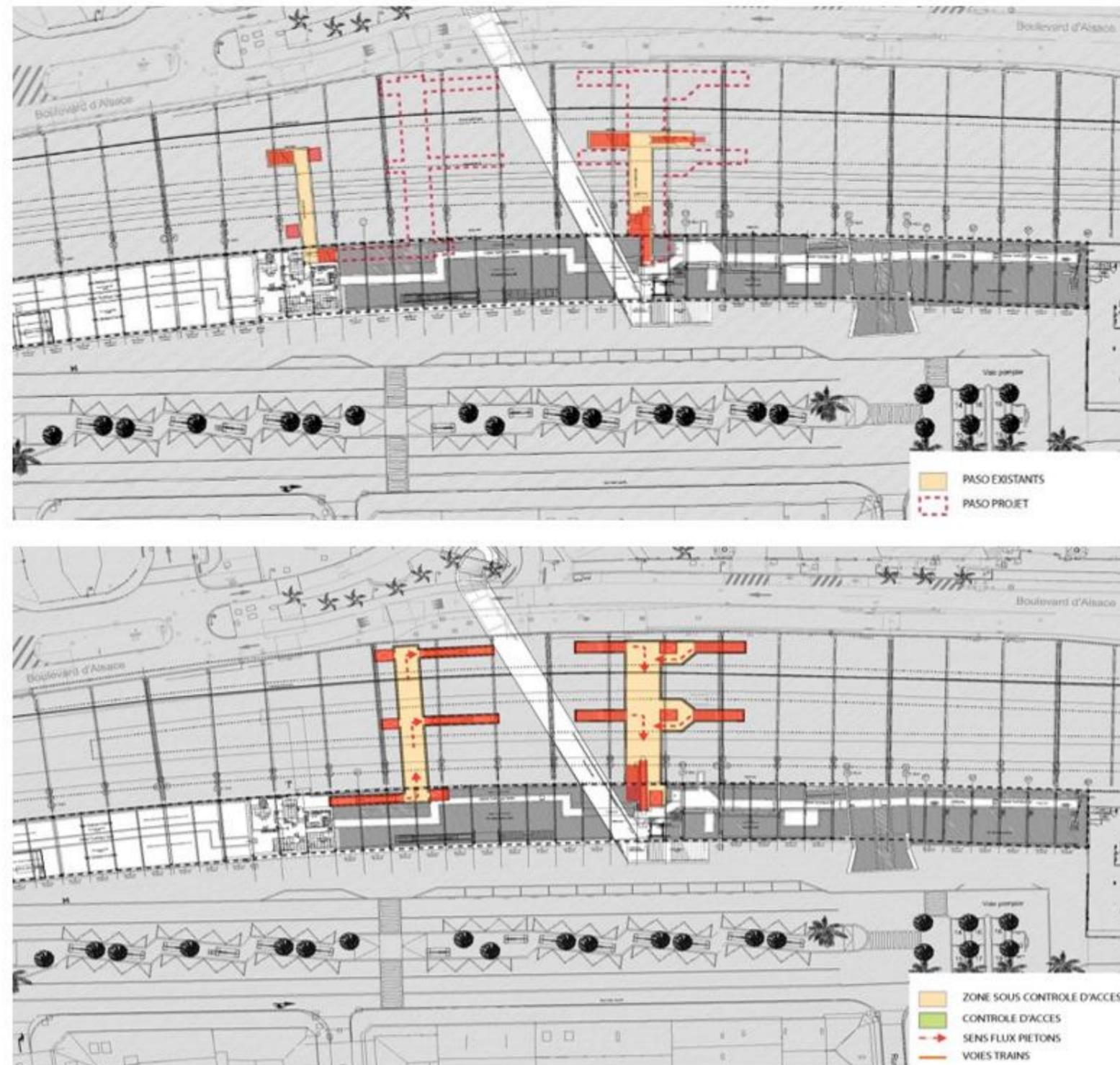
Figure 14 : passages souterrains existants et projetés (figure du haut) – passages souterrains projetés (figure du bas) (AREP, 2021)
