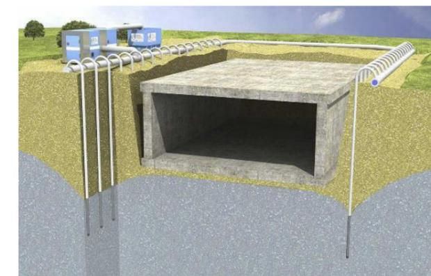
Figure 81 exemple de rabattement de la nappe par pointes filtrantes (Systra, 2021)
