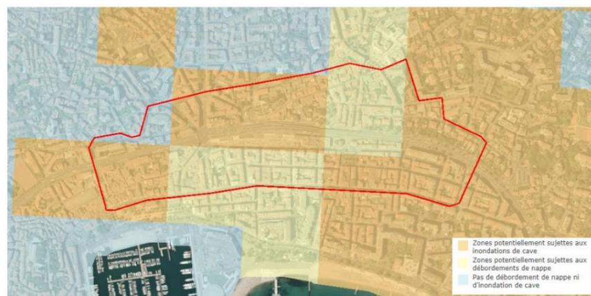
Figure 47 : Risque de remontées de nappe (Source : Géorisques)
