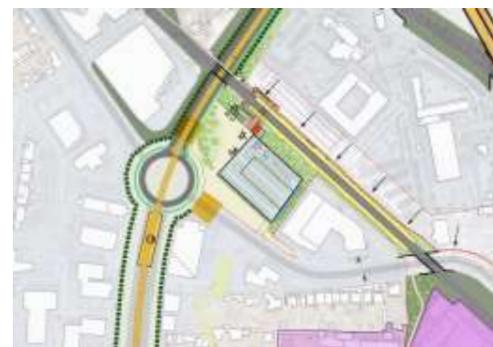
Figure 59 : principe d'aménagement de la halte de Saint-André et de son pôle d'échange (avec option tramway nord en haut, tramway sud en bas à droite)
