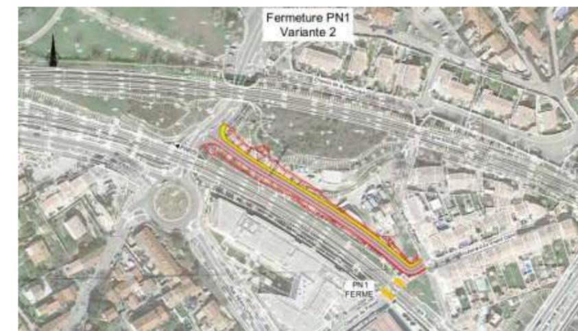
Figure 60 : Principe de remplacement du passage à niveau de St-Henri
