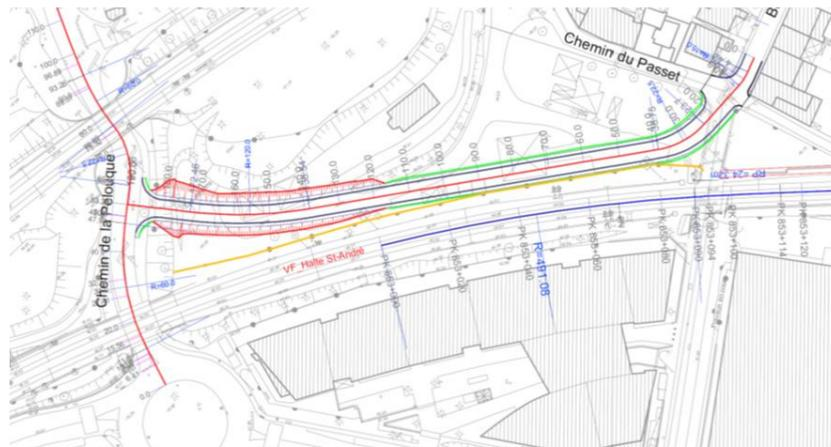
Figure 31 : Suppression du PN1 chemin du Passet (source : Systra, 2021)
