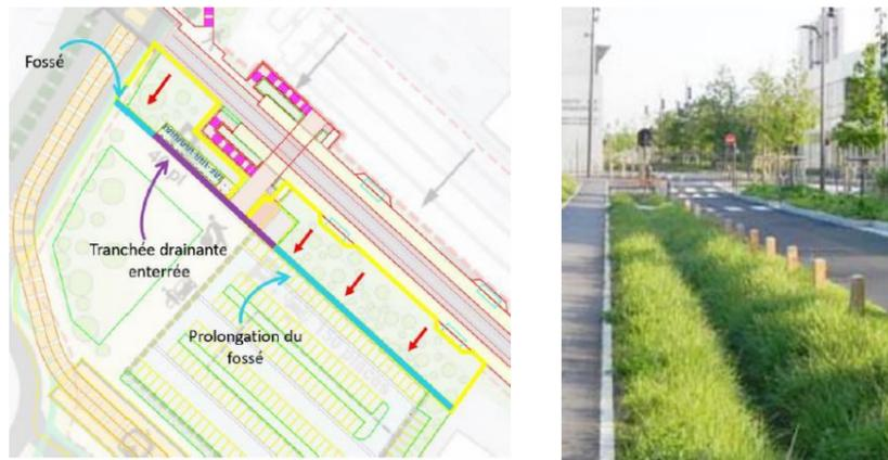
Figure 48 : Principe de gestion des eaux pluviales issues du talus et exemple de fossé enherbé (source : notice hydraulique – AREP – 2021)
