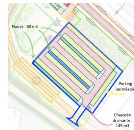
Figure 47 : Principe de gestions des eaux pluviales issues du parvis et du passage sous-terrain (source : notice hydraulique – AREP – 2021)
