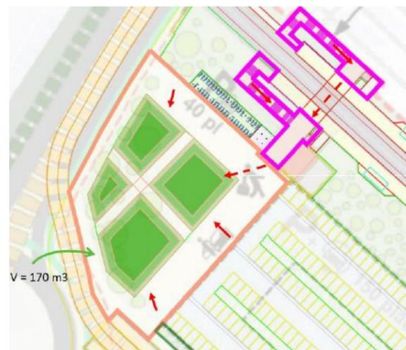
Figure 43 : Principe de gestions des eaux pluviales issues du parvis et du passage sous-terrain (source : notice hydraulique – AREP – 2021)
