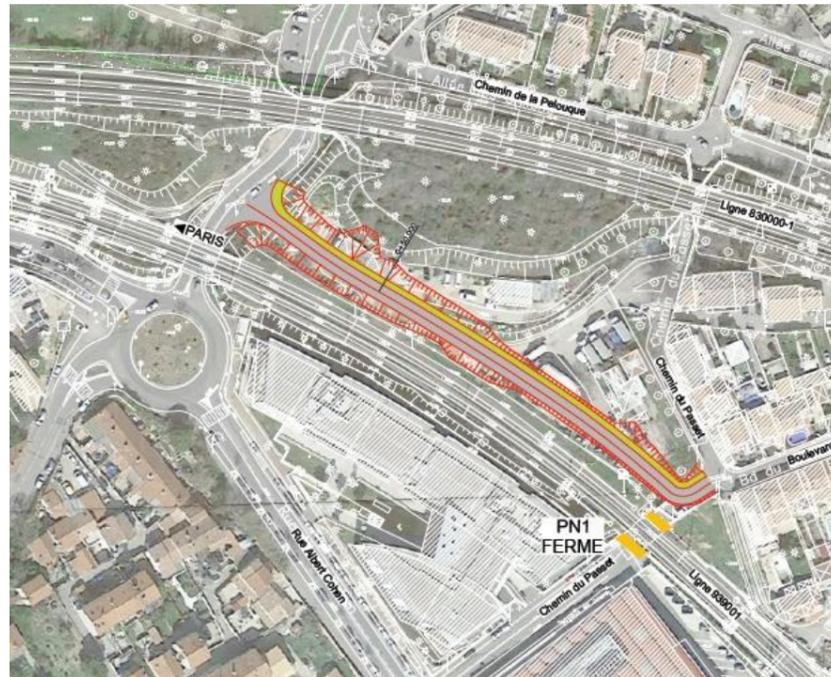
Figure 30 : Fermeture du PN1 et rétablissement routier (source : dossier de concertation « projet de halte de Saint-André et remplacement des passages à niveau – mars avril 2021)
