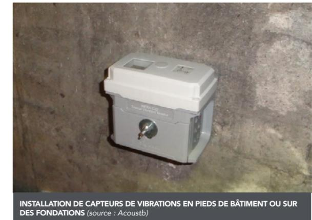
INSTALLATION DE CAPTEURS DE VIBRATIONS EN PIEDS DE BÂTIMENT OU SUR DES FONDATIONS (source : Acoustb)
