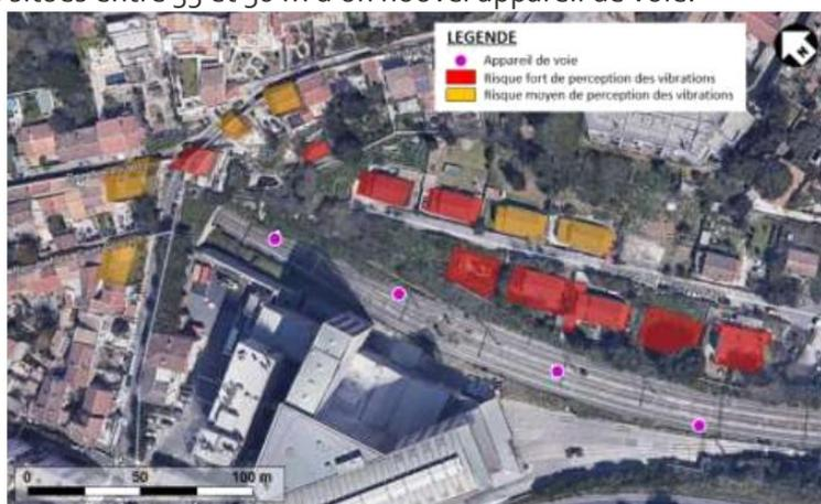
*Vue aérienne – Identification des risques vibratoires à l'intérieur des bâtiments situés à proximité directe des voies ferroviaires (source : Acoustb, 2021)*
