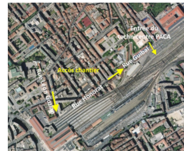
Figure 72 : accès possibles au chantier (source : Systra, 2021),
