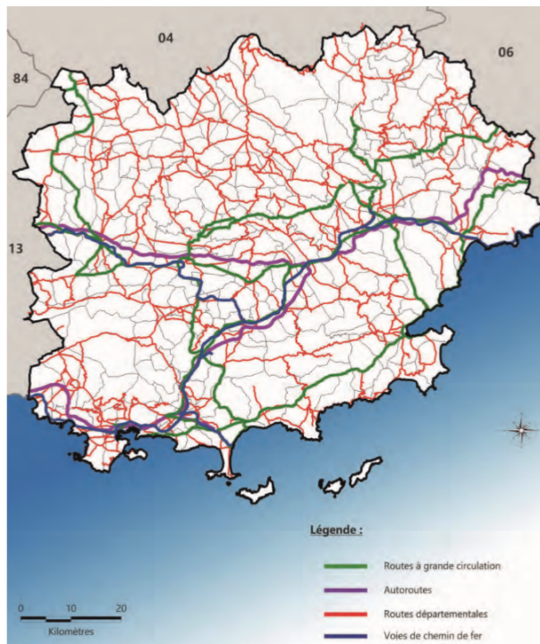
Figure 228 : Principaux axes routiers et ferrés concernés par le TMD dans le département du Var (DDRM 83, préfecture du Var)
